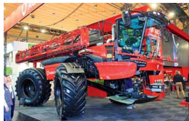
Nejvýkonnějším postřikovačem Agrifac je model Endurance 8000. Na Agritechce byl vystaven jak s kulturními pneumatikami (levá strana postřikovače), tak flotačními, které jsou vidět na fotografii. Foto Luboš Stehno
