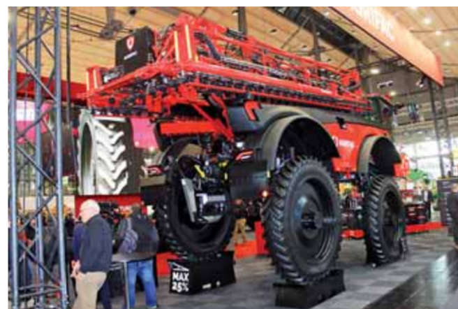
MountainMaster je doplňková výbava, která využívá individuálně ovládané hydraulické válce na každém náboji kola k plné kompenzaci svažitosti až do 20 % ve směru jízdy a 25 % ve směru příčném. Foto Luboš Stehno
