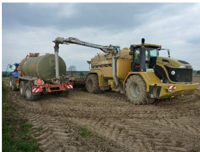
Obr. 4: Dovož a aplikace digestátu samojízdným nosičem výměnných nástaveb TERRA GATOR 3244-SS v družstvu Pooslaví Nová Ves
