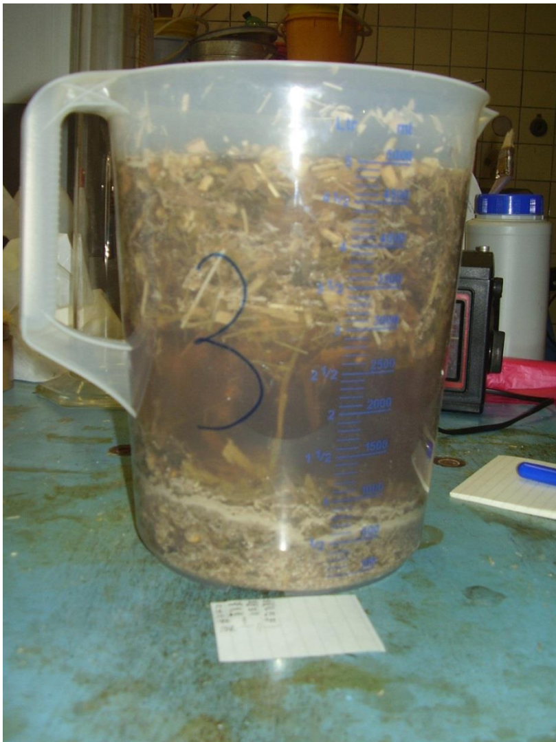
Obr. 6 Separace mokrou cestou s využitím nádoby s kalibrací na 5 litrů
