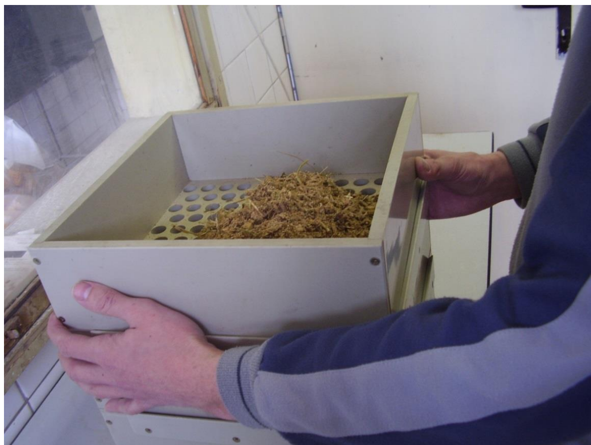
Obr. 2: Třepací box se síty 19 a 8 mm.
