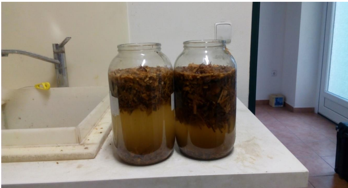
Obr. 6 Separace mokrou cestou s využitím nádoby s kalibrací na 5 litrů
