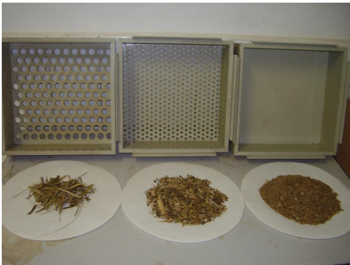
Obr. 3: Rozložený třepací box se sítí 19 a 8 mm, včetně materiálu po protřepání
