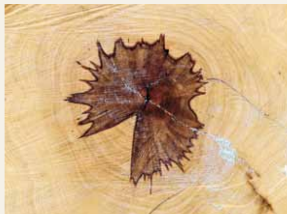
Na fotografii čela bukové kulatiny je zřetelně vidět paprscitě nepravé jádro způsobené houbovou infekcí.
