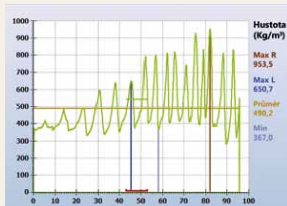
Graf hustotního profilu dřeva douglasky, získaný pomocí rentgenového záření. Z levé strany od dřevěné kůry ke kůře.
