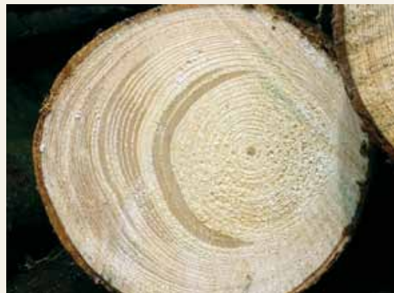
Foto čela kmene smrku, kde lze křemenitost snadno rozeznat v podobě tmavých zón.
