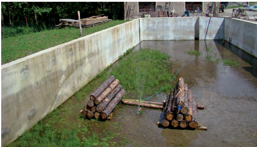
Obr. 4: Skládka ochraňovaná skrápěním vodou
