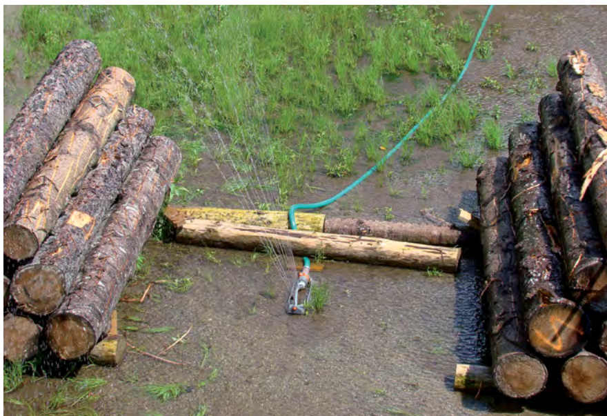
Obr. 5: Detail skrápěcího zařízení v činnosti
