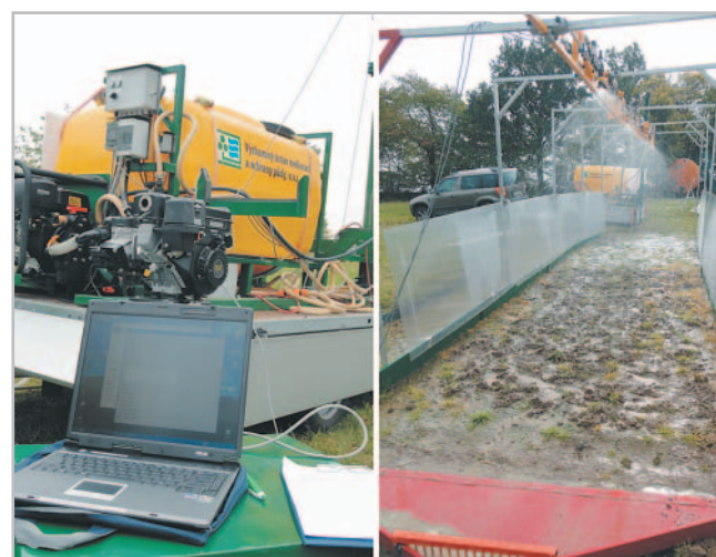
Vyvinutý a zkonstruovaný polní simulátor deště Foto Jan Vopravil
